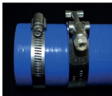
La abrazadera de la izquierda es **sin fin** con anchos de 8mm-13mm y la abrazadera de la derecha es **t-bolt** con ancho de 19mm.
